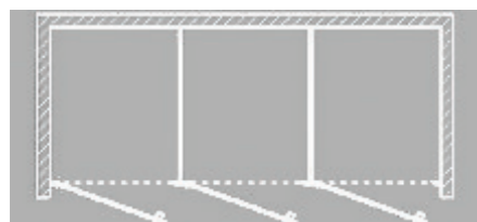
I - montowane pomiędzy ściany
